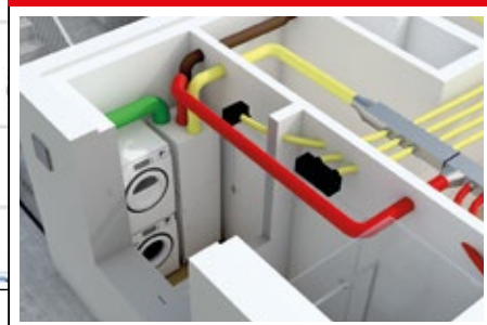
Appareil de ventilation dans le réduit
