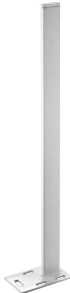
**Verwendung:** Die Standkonsole kann mit den entsprechenden Schiebeteilen für jeden Heizkörpertyp verwendet werden. Die Stabilität sollte für eine freistehende Montage bis zu einer Konstruktionshöhe von ca. 1000 mm genügen. Massgebend sind die Beschaffenheit des Untergrundes, die Grösse des Heizkörpers sowie spezielle Anforderungen. Bei erhöhten Anforderungen ist eine obere Fixierung der Standkonsole zu prüfen.
